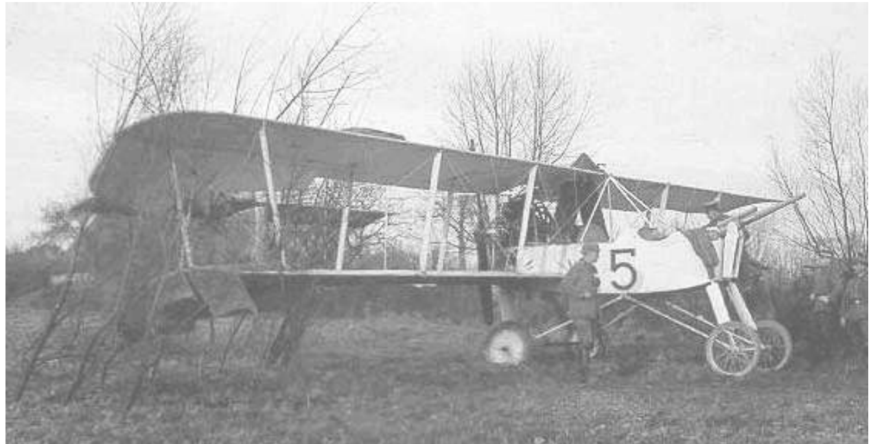
Voisin V, à moteur Salmson Canton-Unné 150 HP Mise en service : 1915
