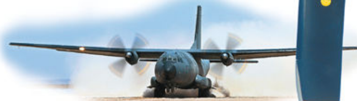
Deux turbopropulseurs Rolls-Royce (6000 CV chacun), hélices quadripales en composite fabriquées par Ratier-Figeac.
